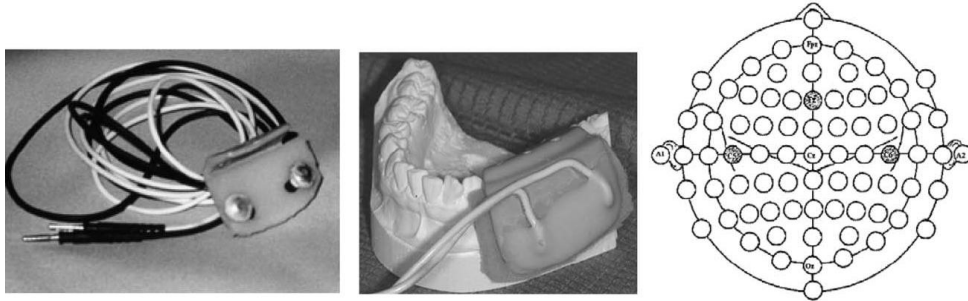
14. ábra. A kiváltott potenciál mérőeszközei. A stimuláló elektróda, a stimuláció vázlata a megfelelő helyzetben, a skalp elektródák helye [4].
