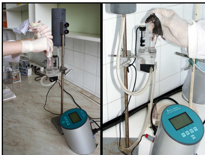
14. ábra. Lábtérfogat mérése Ugo Basile pletizmométerrel
