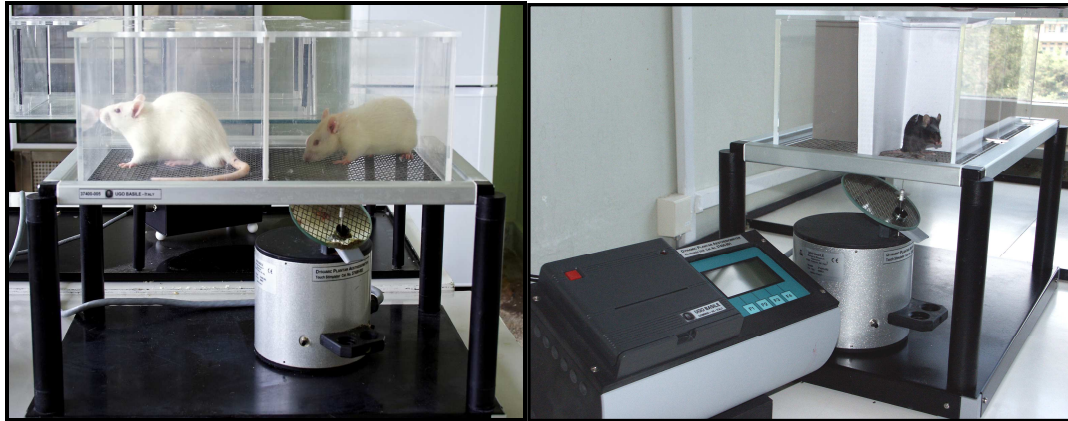
15. ábra. Talp érintési érzékenységének meghatározása Ugo Basile dinamikus plantáris eszteziométerrel
