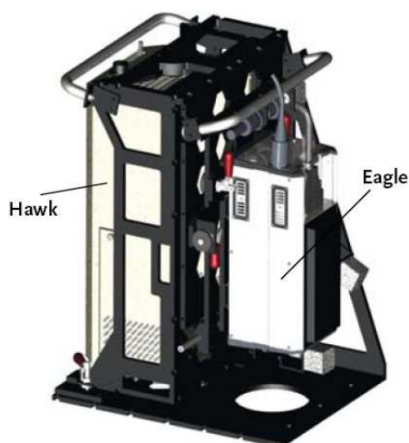
37. ábra: Az AISA-Dual hiperspektrális szenzor felépítése (Forrás: AISA Dual, Spectral Imaging Ltd., Finnország)
